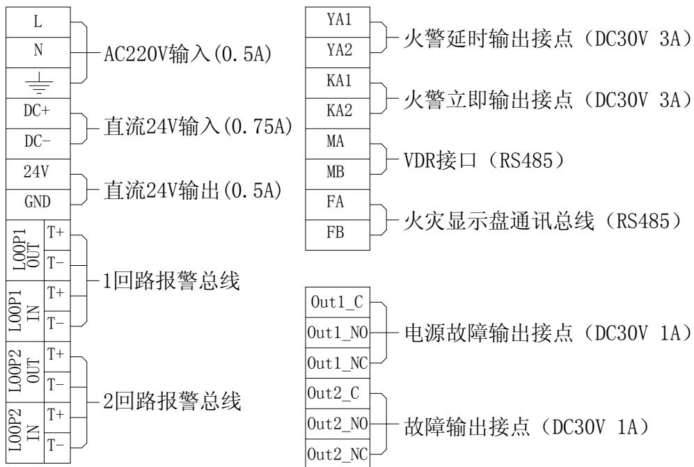
图 4 控制器的外接线端子示意图
